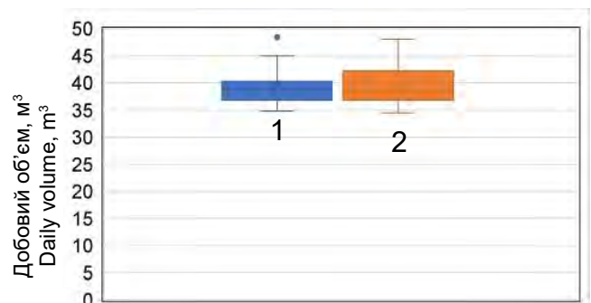
Рис. 35. Загальний добовий об'єм випаровування газоподібного азоту з 4-х контейнерів «Chart MVE 1400». 1 — у лютому, 2 — у липні.
