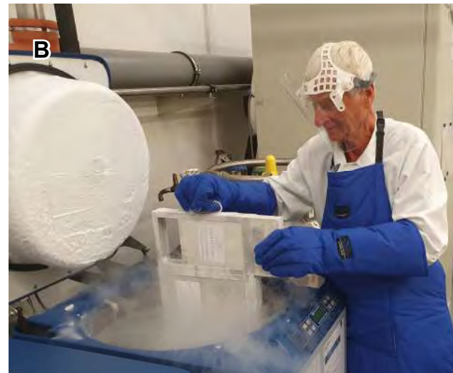
Рис. 22. Технологічна операція зі зберігання кріоконсервованих трансплантатів: велика підшкірна вена в кріоконсервуючому розчині, запаяна в подвійний поліетиленовий пакет для заморожування «EVA» (Maco Biotech, Франція) (А); робота з металевими касетами для захисту пакетів з трансплантатами, які зберігаються в малому контейнері «KryoCE10K» (Taylor-Wharton, Німеччина) (В).
