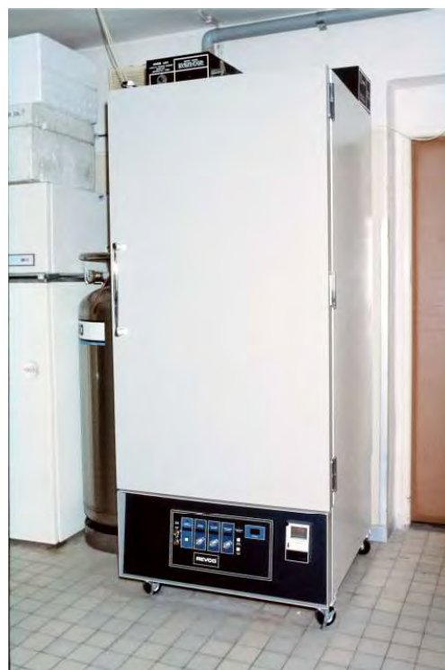
Рис. 4. Морозильна камера «Revco ULT» («Rheem Scientific», США) з резервною системою охолодження рідким азотом.
