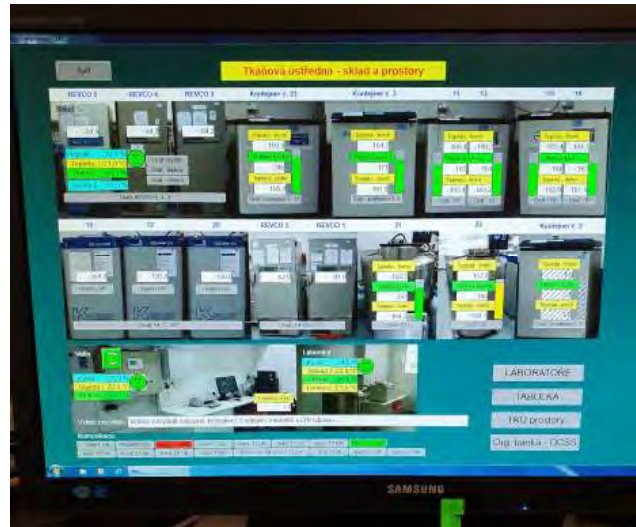
Рис. 31. Візуалізація значень температури та рівня рідкого азоту всередині контейнерів з біологічними речовинами. Попереджувальні значення виділені жовтим кольором, аварійні — червоним.
