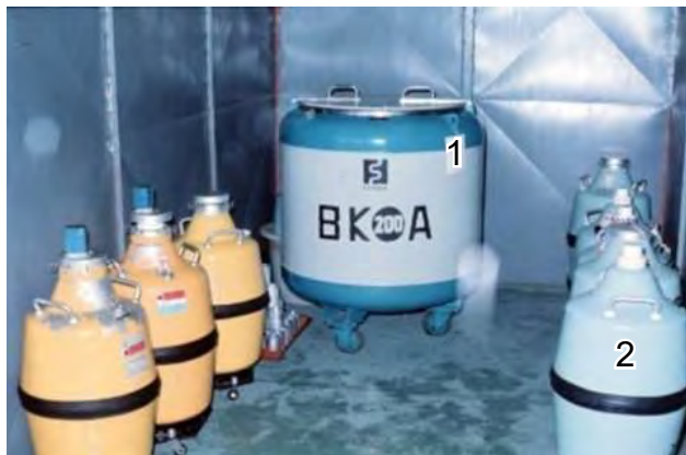
Рис. 3. Великий біологічний контейнер BK 200 A (Ferox Děčín, Чехословаччина), для зберігання кріоконсервованих ГКП (1) та невеликі резервні посудини Дьюара (STS Říčany) (2).
