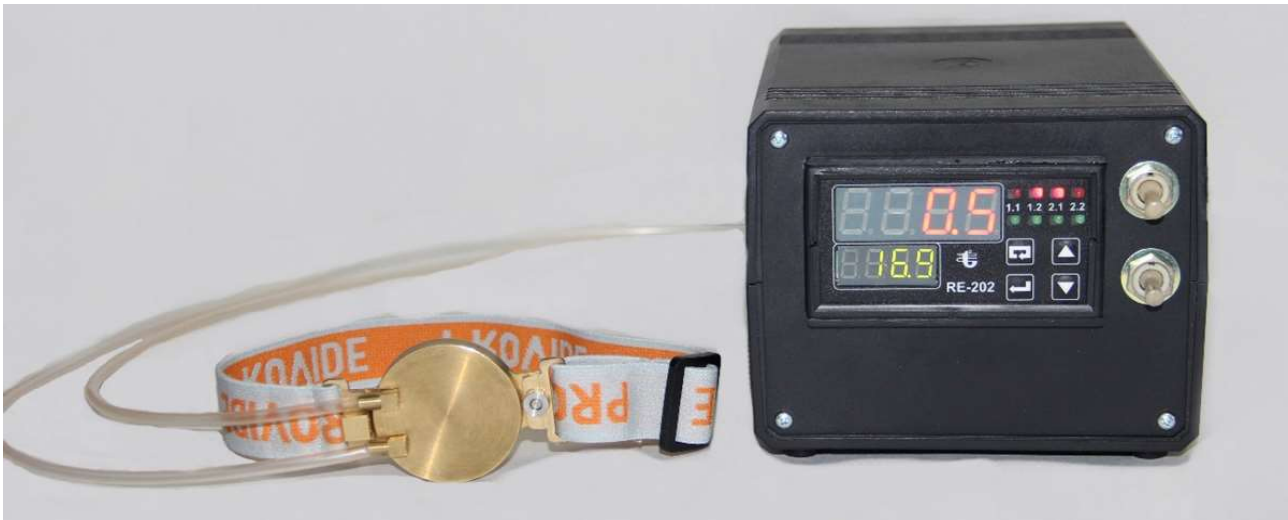
Рис. 2. Зовнішній вигляд термоелектричного приладу для контактної охолодження ока: зліва — охолоджувальна пластина, справа — термоелектричний електронний блок охолодження, керування та живлення.
